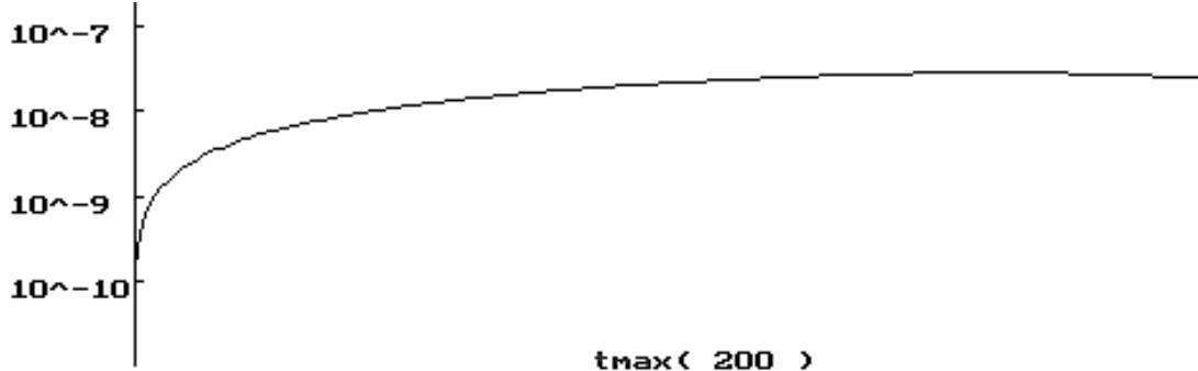
FIG.28a-Évolution d'un écart \delta de deux C.I. proche de (1/2, 0) , en fonction du temps (courbe SCI) pour K = 3.7 . On remarque que le point de nature elliptique n'engendre pas la SCI.
