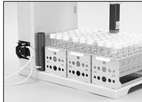
Suportes de frascos instalados
