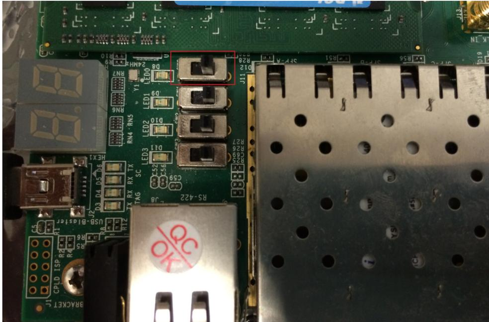
**Figure 1: SW0 switch OFF position**
